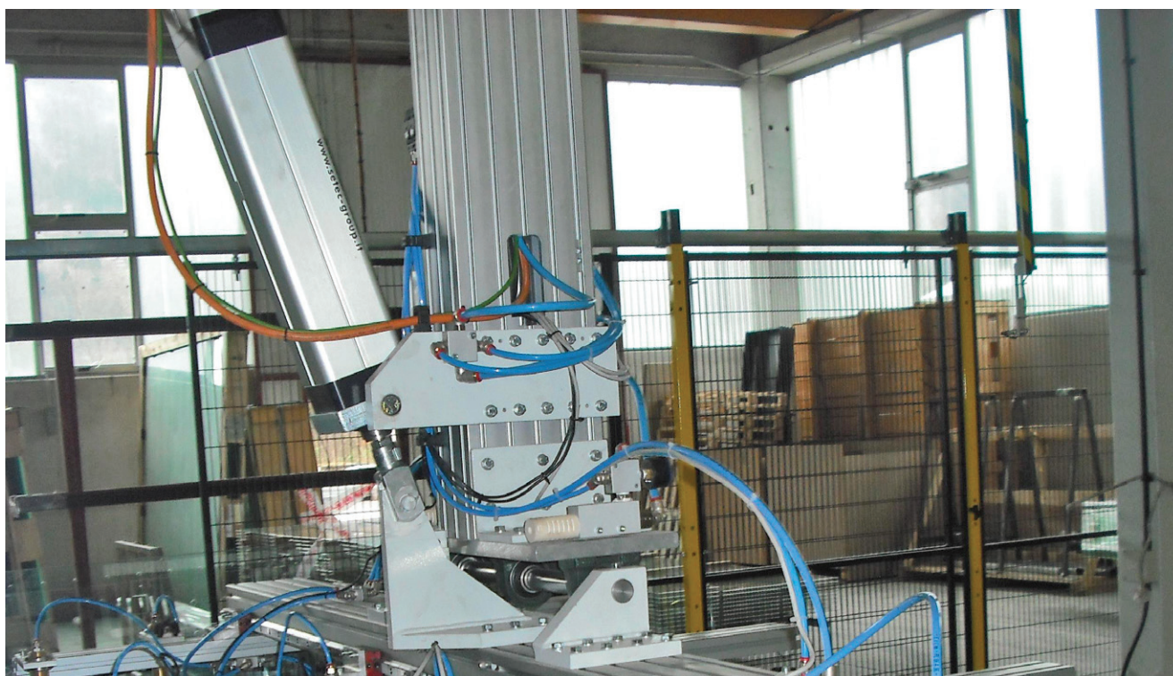
Ribaltatore lastre in vetro / Glass panel tilter
