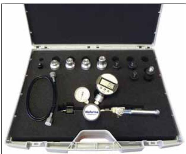
Gasfeder-Füllkoffer zum füllen und anpassen von Gasfedern vor Ort. Der Koffer enthält alle notwendigen Füllglocken und Ablaßschrauben für unser aufgeführtes Produktprogramm. Der Füllkoffer ist passend für 200 bar Stickstoff-Flaschen mit Gewinde W24,32x1/14". Stickstoff ist im Lieferumfang nicht enthalten.
