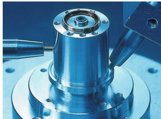
FDB モータの回転特性分析 Analysis of FDB Motor's rotational characteristics
