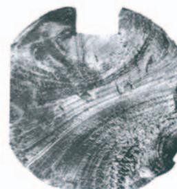
**Bild 3:** typischer Ermüdungsbruch
