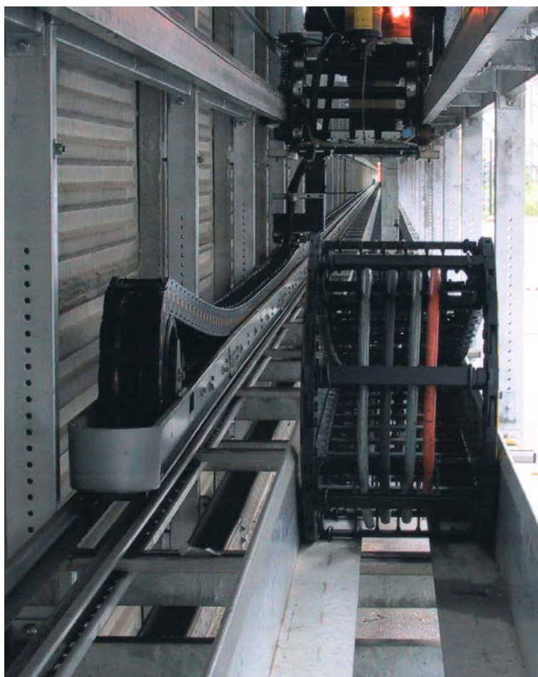
Impianto prova catene per corse lunghe Lunghezza corsa m 130 Velocità 8 m/s
