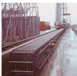
Catene BS3500 dotate di carro mobile applicate su impianto di De Icing presso l'aeroporto di Monaco di Baviera D. Lunghezza corsa m. 90. Velocità di scorrimento m 90 al minuto.
