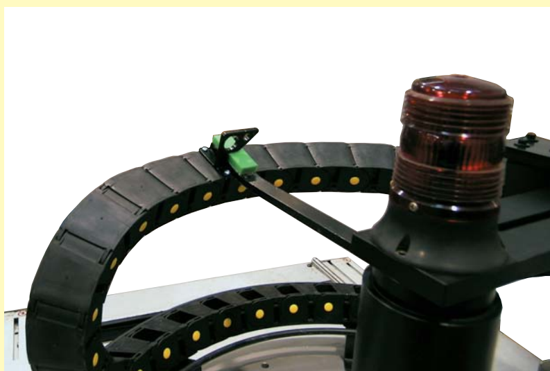
Applicazione di due catene ad anello tipo SR495 con gancio di sostegno.
