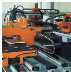
Catene in nylon della serie Heavy su macchine operatrici.
