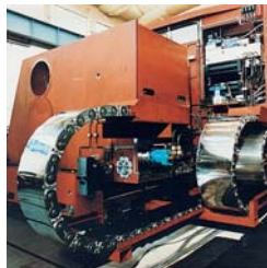
Catene in acciaio della serie Steel tipo BS 3000.
