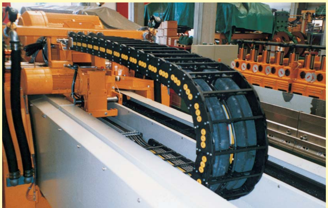
Catena in nylon tipo SR310 in regime di autoportanza.
