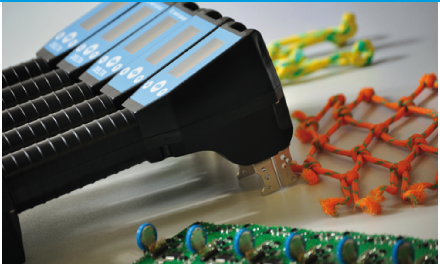
Fischnetzmaschenmessgerät - Beispiel eines elektronischen Regelsystems mit Kraft-Längen-Messung (Motor, Systemsoftware und Elektronik von ASTRO)
